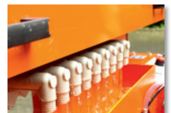
Filterausgang mit Ablaufrinne
