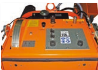
Übersichtliches Bedienpult mit Schnitttiefeanzeige
