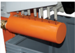
Filterausgang mit Ablaufrinne
