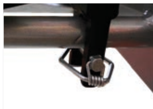
Motor abnehmbar über Schnelltrennsystem
