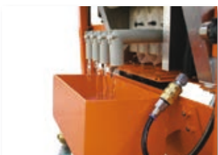
Filterausgang mit Ablaufrinne
