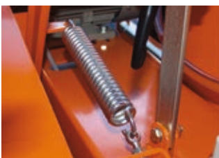
Gefederter Schneidkopf für stufenlose Höhenverstellung
