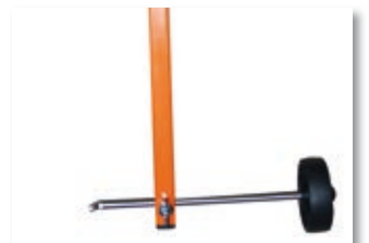
Kontrollierter Schnittverlauf durch Richtungsanzeiger
